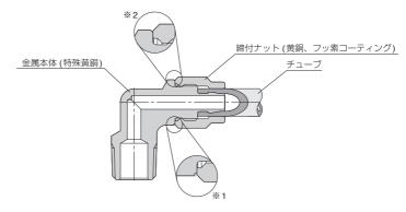
※1. 識別満有りの場合の金属本体部形状となります。当形状でご使用できる接続チューブの内径は、ø5, ø6.5, ø8, ø11mmです。※2. 識別満無しの場合の金属本体部形状となります。当形状でご使用できる接続チューブの内径は、ø2.5, ø4, ø6, ø7.5, ø9, ø13mmです。
